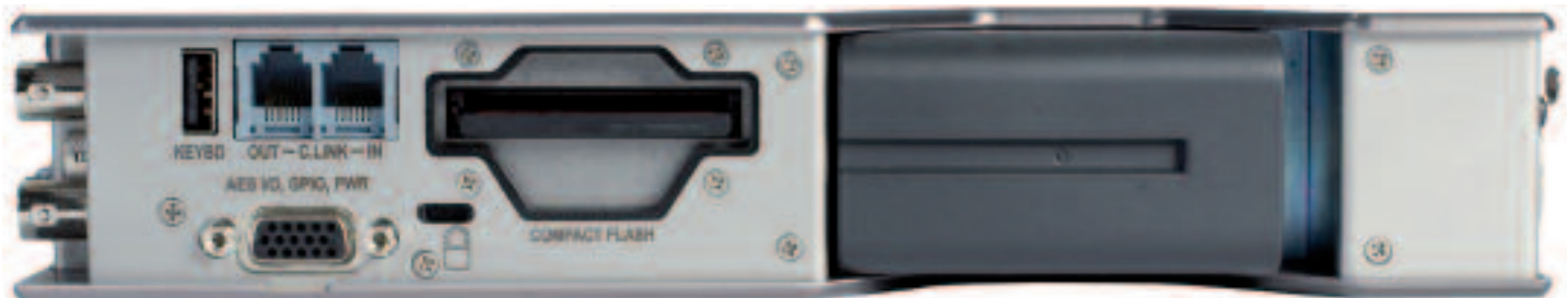
Die Gehäuserückseite des 788T – von rechts: der Lithium-Akku, zur Datensicherung ein Compact Flash Slot und zur Gerätesicherung links davon ein Security Slot zum Anketten. Ein externes USB-Key-board kann die Dateneingabe erleichtern, ein Kombi-DE-15-Anschluss für 8 AES3 in und 2 AES3 out oder wahlweise als Logic in und out.
