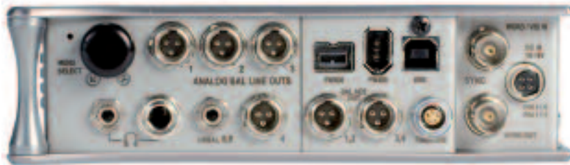
Rechte Seite: Egal ob 3,5 mm oder 6,3 mm: Der Kopfhörer passt immer. Darüber der Multifunktions-Drehknopf für Menueinstellung und daneben die analogen Line-Ausgänge, reichlich digitale Schnittstellen und der Netzgeräteanschluss.
